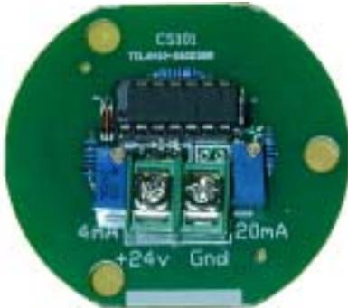
请首先调试 20mA 满偏电流：将随机调整磁钢置于传感器上端标志处(或上满液)调节变送器内的满偏微调(20mA)校准 20mA 满偏电流；
